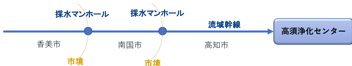
図 4-5 流域幹線マンホール採水箇所の模式図
