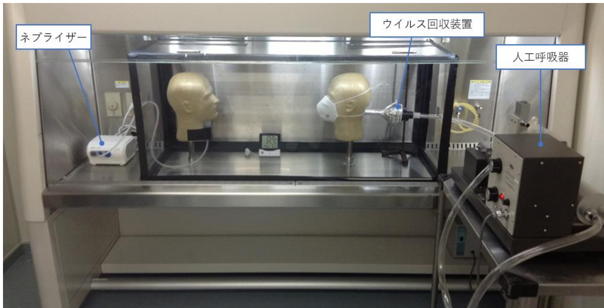
図1 BSL3 施設内に設置したウイルス噴霧チャンバー
